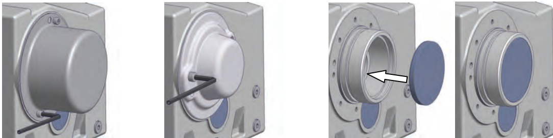
Bild 3-13: Montage der Abdeckhaube Option SH, Option H und Option H66
